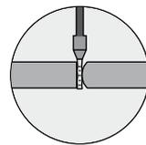
**Mise en contact pneumatique pour des conducteurs individuels avec connecteurs plats, cosses de câble, embouts, extrémités étamées, etc.**
